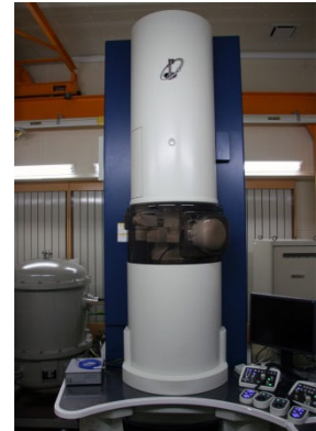
モノクロメータ搭載 低加速原子分解能分析電子顕微鏡 JEM-ARM200F
